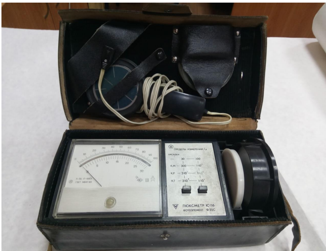
Фото 5. Фотоэлектрический люксметр Ю-116
